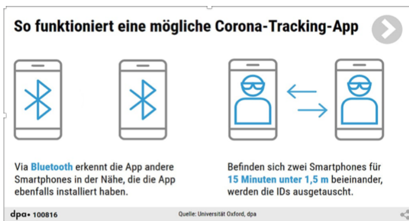
Abbildung 1: Funktionsweise der Corona-Tracing-App
